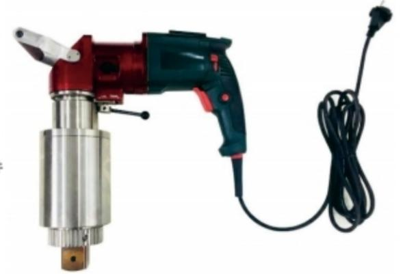
TYDEW-A系列弯柄电动扭矩扳手在工作前，务必将刹车机构锁紧，否则，扳手变速箱部分产生的较大扭矩会直接作用在操作者身上，可能对操作者造成不同程度的人身伤害或财产损失。
